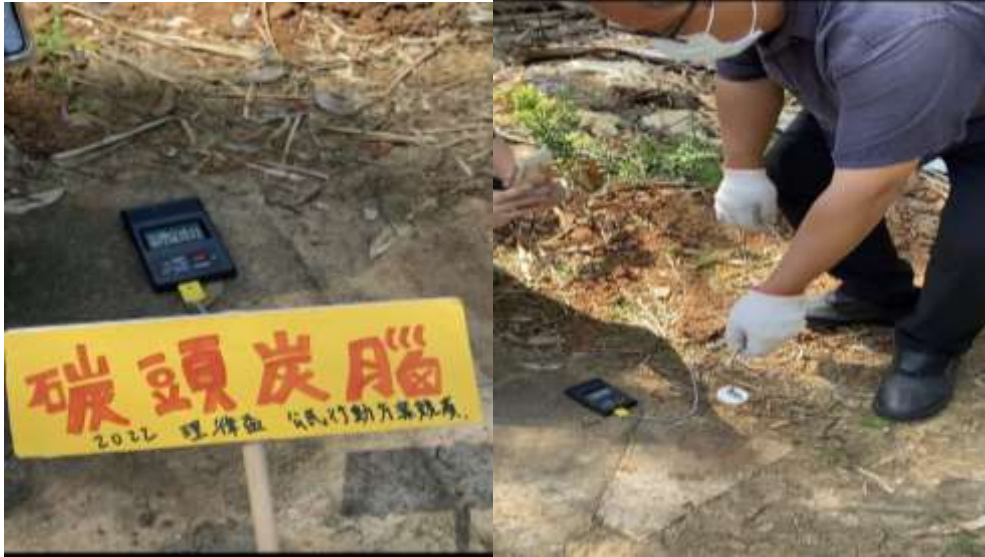
(圖三、可將鐵爐底部裝置溫度計，掌握燒製程度)
