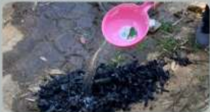
STEP 4. 倒出燒製完畢的竹炭並以水澆濕降溫
